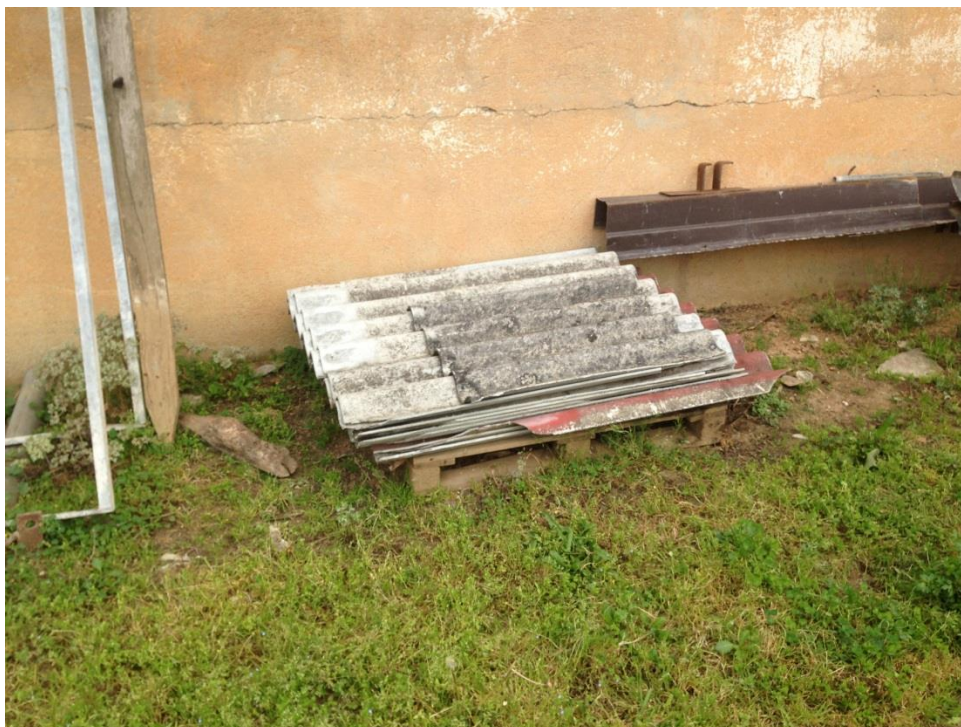
Foto 2.3 – Lastre in cemento amianto
